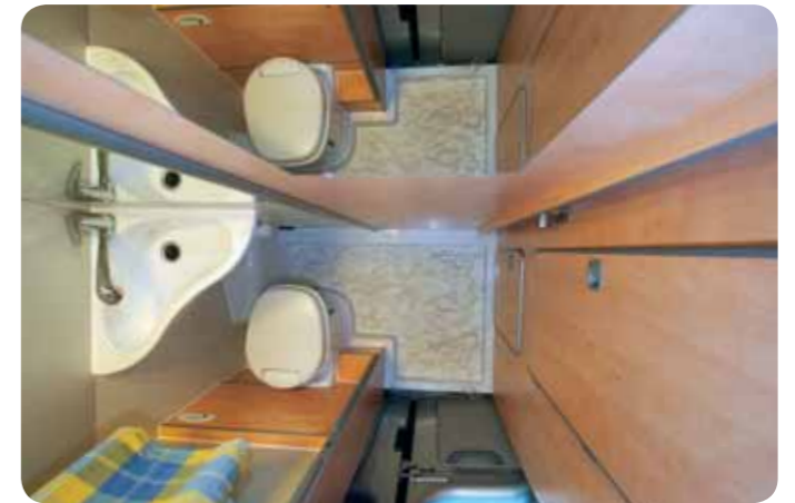
Kompakt, aber flexibel: Dadurch, dass die Türe (mit großem Spiegel) in zwei Stellungen arretierbar ist, lässt sich der Heckbereich variabel nutzen.
